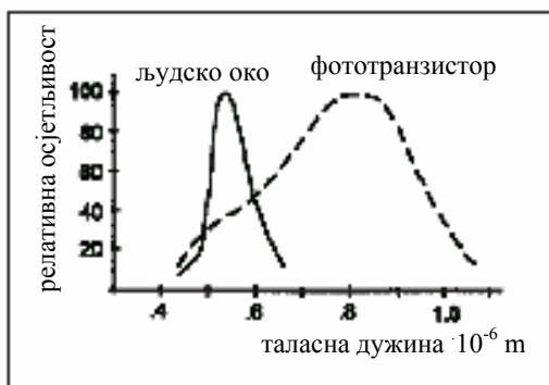
Слика 4. Осјетљивост људског ока и фототранзистора у зависности од таласне дужине свјетлости
