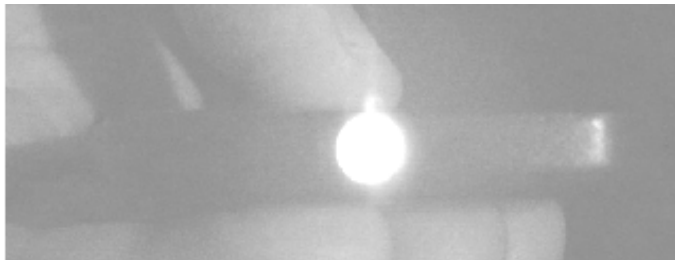
Слика 3. ИС зраци које емитује даљински управљач снимљен дигиталним фотоапаратом
