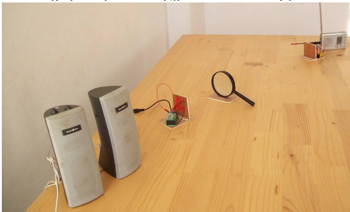
Слика 4. Лупа између предајног и пријемног кола омогућава успјешан пријем одасланог инфрацрвеног зрачења и потврђује важење закона геометријске оптике
